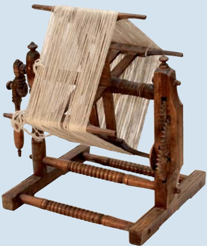
Hölzerne Garnhaspel mit akustischem Zählmechanismus zur exakten Bestimmung der Garnmenge.
